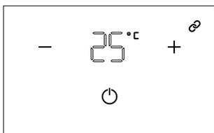
En el modo **ENCENDIDO**, la temperatura ambiente actual y los iconos de más, menos y estado (es decir, el estado de la conexión) aparecen en la pantalla. Este modo le permite modificar el punto de ajuste de temperatura y cambiar entre **APAGADO** y **ENCENDIDO**.
