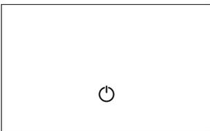
Después de 20 segundos de inactividad, el termostato entra en modo de suspensión y la pantalla se apaga. El anterior punto de ajuste o modo de funcionamiento (modo AUTOMÁTICO, manual o de protección) funcionan en segundo plano. Active el termostato tocando el botón de espera.
