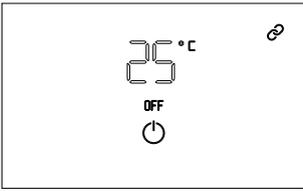
Al tocar el botón de espera en el modo **ENCENDIDO**, el termostato activa el modo de protección (APAGADO). Entonces, aparece la palabra **OFF** (apagado). Si la temperatura desciende por debajo de los 8 °C, el termostato activa la salida de calefacción de forma automática hasta que la temperatura alcanza los 8 °C.
